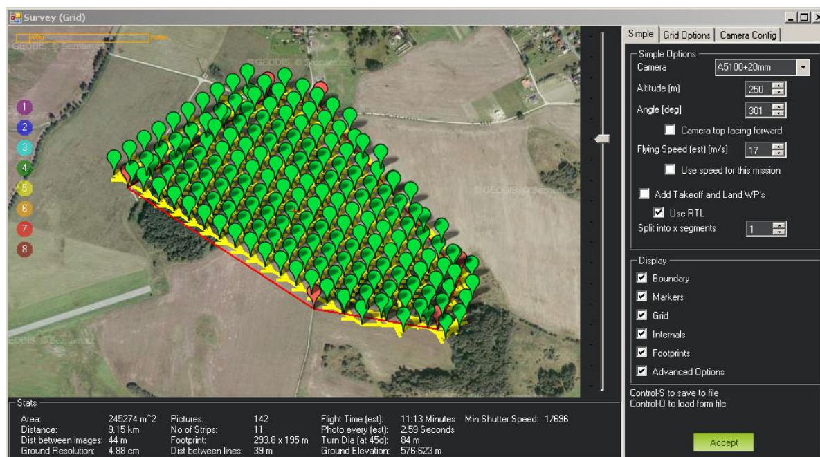
Obr. 10 Příklad plánování snímkovací mise v prostředí open-source nástroje Mission planner. Na mapě jsou viditelné předpokládané pozice jednotlivých expozic.
